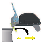
10 - Bouton de déblocage mouvement horizontal disque détalonneur supérieur et inférieur.
