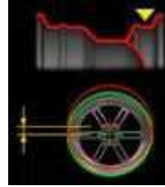
radialer Seitenschlag des Sitzes des externen Reifenwulsts (1. Grundschiwingung);
