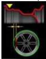
l'eccentricità radiale della sede del tallone interno dello pneumatico (pico-picco);
