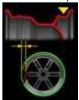
l'eccentricità radiale della sede del tallone esterno dello pneumatico (pico-picco);
