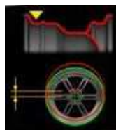
la excentricidad radial del alojamiento del talón interno del neumático (1ª armónica);
