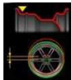
la excentricidad radial del alojamiento del talón interno del neumático (pico-pico);
