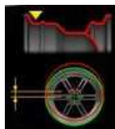
la excentricidad radial del alojamiento del talón externo del neumático (1ª armónica);
