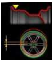
l'eccentricità radiale della sede del tallone interno dello pneumatico (1° armonica);
