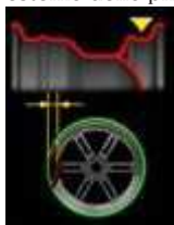
l'eccentricità radiale della sede del tallone esterno dello pneumatico (picco-picco);
