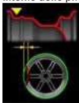
l'eccentricità radiale della sede del tallone interno dello pneumatico (picco-picco);
