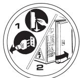
Vor Servicearbeiten an der Maschine den Netzstecker aus der Steckdose ziehen.
