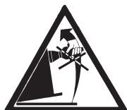
Radträgerwelle nie als Anschlagpunkt zum Heben der Maschine verwenden.
