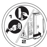
Desconectar el enchufe de la toma de alimentación antes de efectuar intervenciones de asistencia en la máquina.
