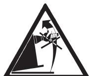
No utilizar el perno portarrueda como asidero para levantar la máquina.
