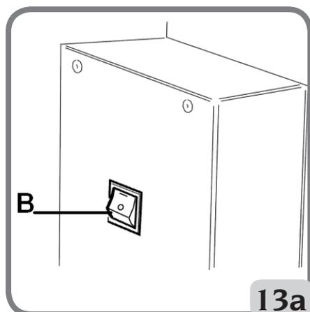
L'equilibratrice esegue un test di controllo e, se non vengono rilevate anomalie, emette un segnale acustico e visualizza il marchio e i dati di personalizzazione, dopodiché attende l'inserimento dei dati geometrici della ruota.
