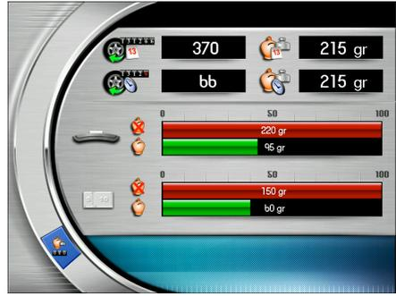
**Remarque : les paramètres affichés par les totaliseurs sont mis à jour à chaque lancement en fonction du programme Less Weight sélectionné.** L'icône **Reset** sert à effacer les totaliseurs partiels.
