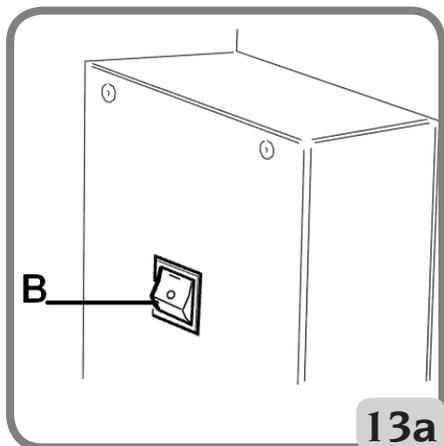
L'équilibreuse effectue un test de contrôle et, si aucune anomalie n'est relevée, elle émet un signal acoustique et affiche la marque et les données de personnalisation, ensuite elle attend la saisie des données géométriques de la roue.
