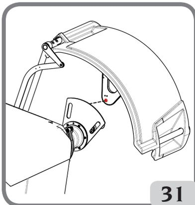
**La visualización del mensaje A20** indica, en cambio, que la posición del medidor en fase de calibración no es correcta. Colocarlo por tanto de forma correcta, como se describe más arriba, y repetir el procedimiento. **La visualización del mensaje A20** indica que:
