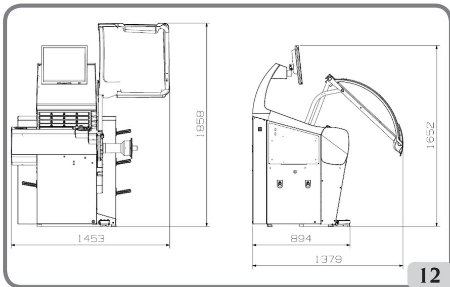
profondeur avec protection fermée ..... 1379 mm
