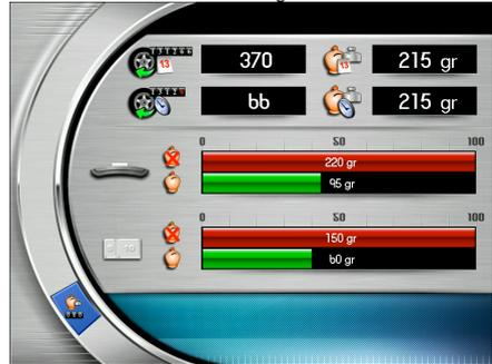
**HINWEIS:** die von den Zählern angezeigten Werte werden bei jedem Messlauf mit Bezug auf das ausgewählte Programm Less Weight aktualisiert.
